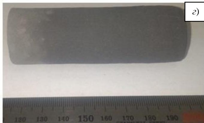
Рисунок 56 – Внешний вид компактных заготовок Nb_3Al , получаемых вакуумным спеканием 1700\text{ }^{\circ}C прессовок из порошка Nb-7,4Al : а) \varnothing 43 , l = 204 мм, m = 2,2 кг; б) \varnothing 37 , l = 200 мм, m = 1,5 кг; в) \varnothing 30 , l = 87 мм, m = 0,45 кг
