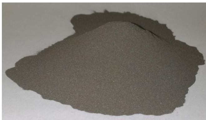
Рисунок 43 – Свободно насыпанный порошок Nb-6,45Al, полученный гидридно-кальциевым методом
